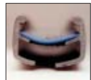
Der komplette Felgenboden ist bedeckt. Das Band kann nicht verrutschen.
